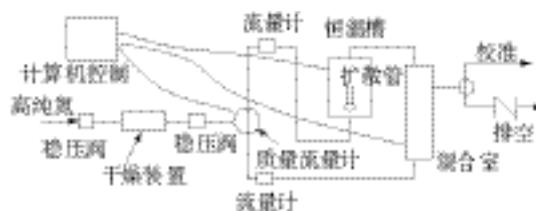
图 1 动态配气装置示意图
